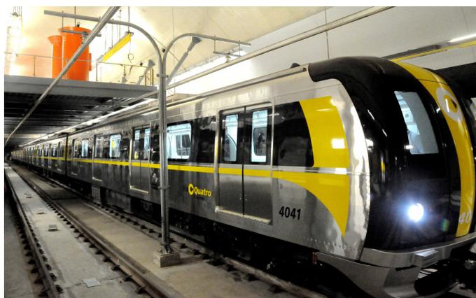
Os trens da Linha 4 são equipados com o que há de mais moderno em operação metroviária. A maior novidade é a tecnologia *driverless*, que permite a operação dos trens sem condutor usando um sistema informatizado. Com a operação automática, há mais segurança: as velocidades são sempre mantidas dentro dos limites permitidos e reguladas de acordo com a necessidade, o que dará mais agilidade à operação dos trens. Na Linha 4, o intervalo entre os trens será de 90 segundos.
